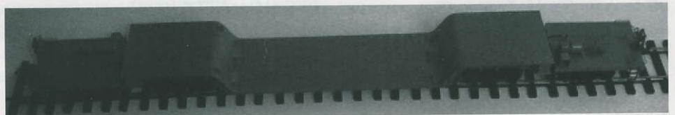
gängern wurden nur die Drehgestelle, Teile der Bremsausrüstung und die Kupplung gekauft. Die Handbremsstände und auch die Tritte sind Eigenbau. Bei diesem Modell wurde erstmals mit einem Widerstandslötgerät gearbeitet. Dadurch lassen sich auch kleine Teile nahe beieinander problemlos anlöten. Das noch im gleichen Jahr! fertig gestellte Modell ist bereits gespritzt wartet nur noch auf seine Beschriftung.
