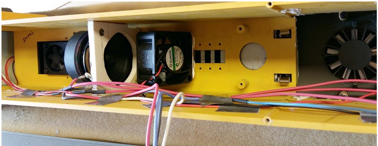
Gehäuse mit Lautsprecher und Ventilator.
