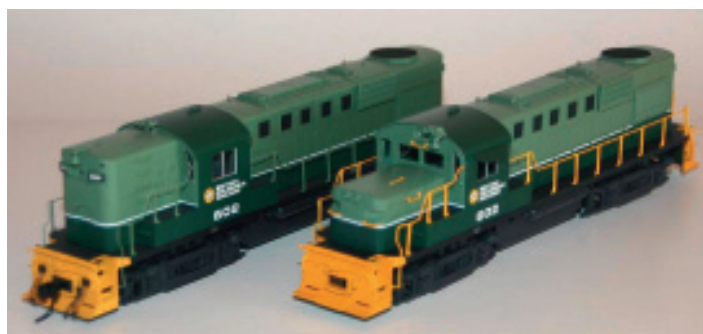
Proto 1000, RS-18, Vergleich zw. vorher und nachher (Umbau von high nose auf low nose) Bild links: Umgebautes Modell, nach dem Spritzen fehlen noch kleine Details
