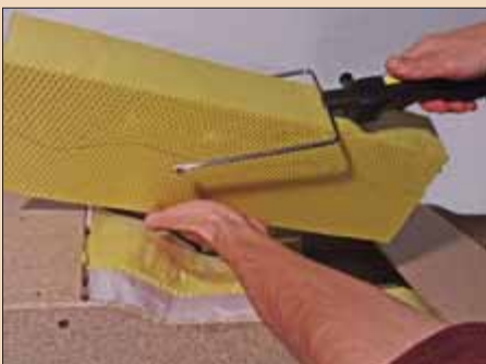
Mit dem „hotwire foam cutter“ wird das Styrodur geschnitten.
