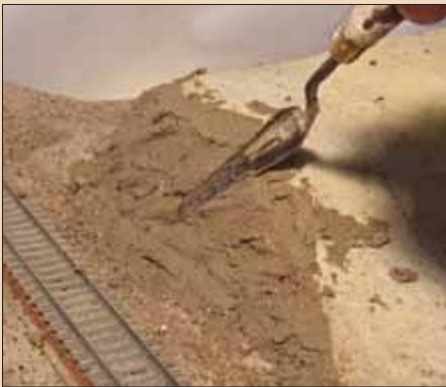
Der Leim-Sand-Brei wird mit einem Spachtel aufgetragen.
