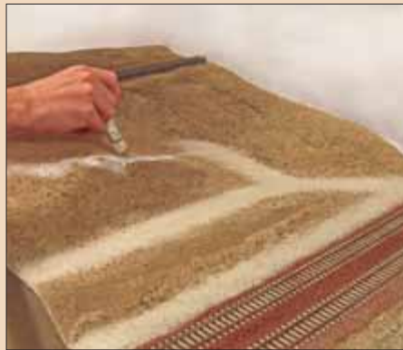
Zum Fixieren wird der zuvor befeuchtete Sand mit verdünntem Weissleim beträufelt.
