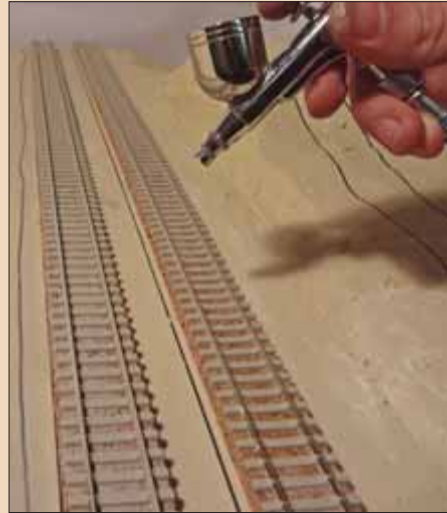
Mit Airbrush wird den Schwellen der Kunststofflook genommen.
